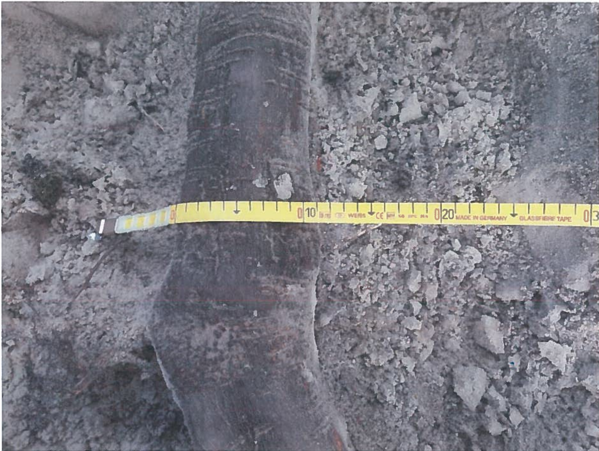
Foto 18: beworteling in proefseuf 4 (t.h.v. boom 092480)
