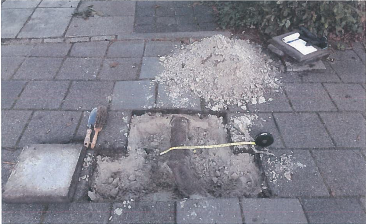
Foto 5: beeld van vrijgegraven oppervlakkige beworteling
