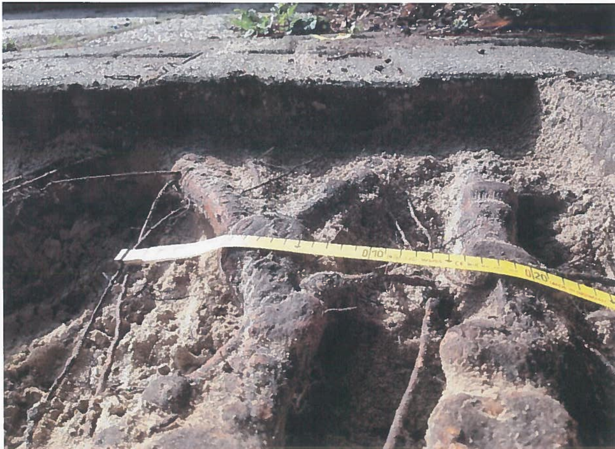
Foto 16: beworteling in proefseuf 3 (t.h.v. boom 092479)
