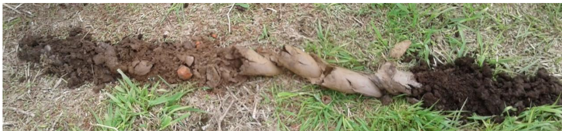
Afbeelding: Bodemprofiel in Zwolle: boven/ links naar beneden/rechts – Bovengrond, gemengde grond met zanderige materiaal, kleilaag, veen
